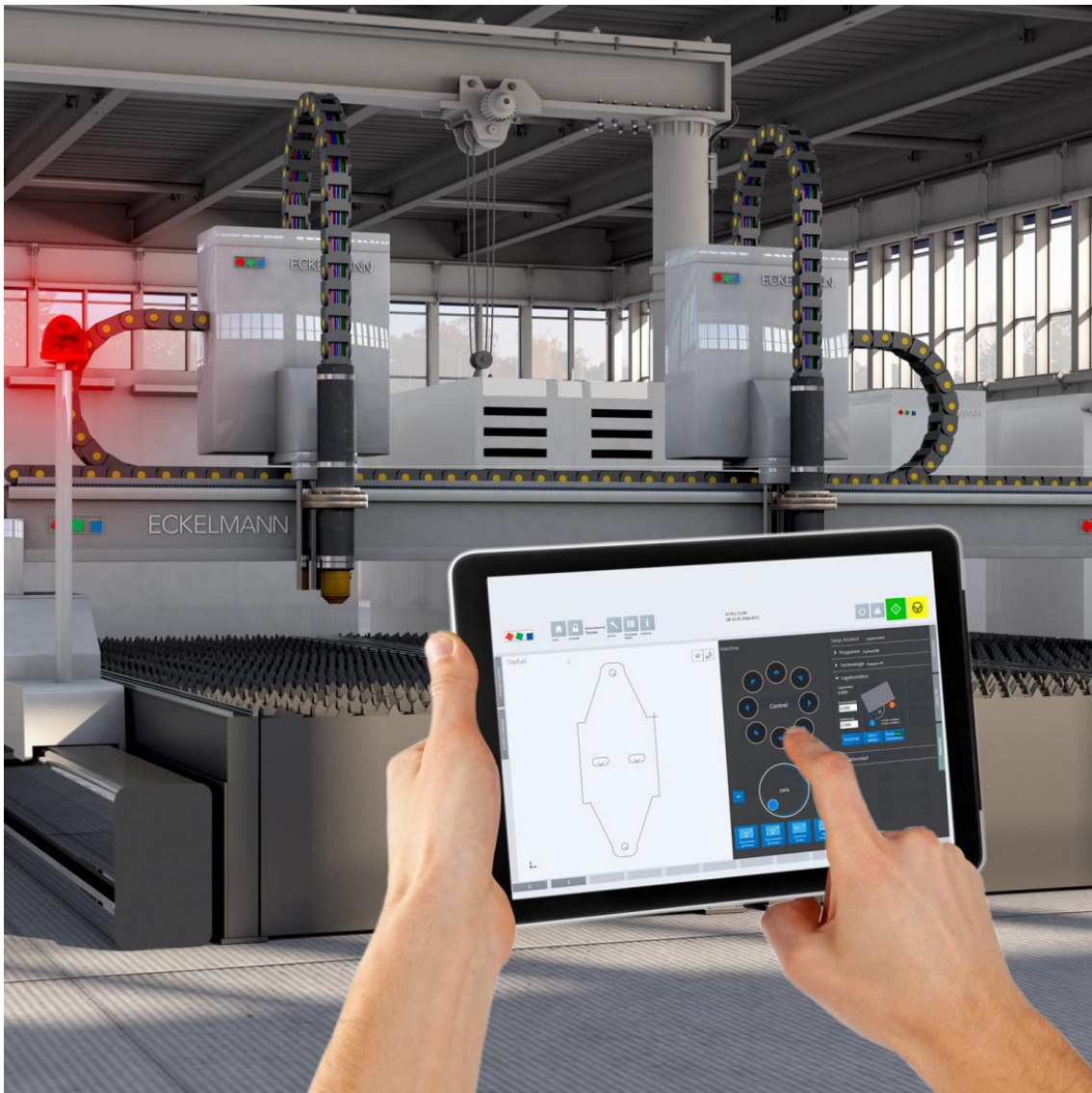
Abb. 3: Per Schneiden-HMI bedienbares 3D-Modell einer Brennschneidmaschine (Foto: Eckelmann AG, © vovan / Fotolia.com (Hände und Tablet) )
